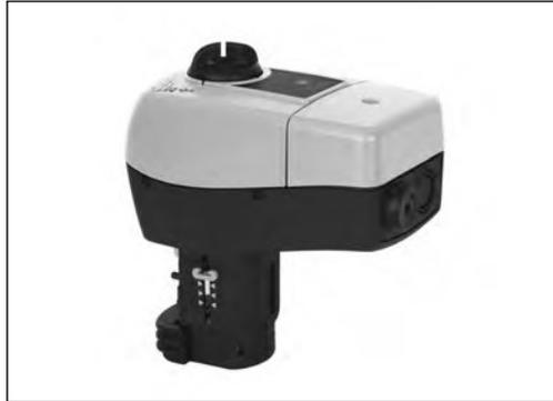
Электропривод предназначен для управления 2- и 3-ходовыми регулирующими клапанами VF3, VL2, VL3 с DN < 80 мм и клапанами VRB и VRG. Приводы имеют концевые моментные выключатели, срабатывающие при возникновении
